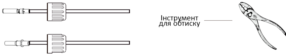
Рис. 3.4 Закріплення контактного штифту на дрiт
